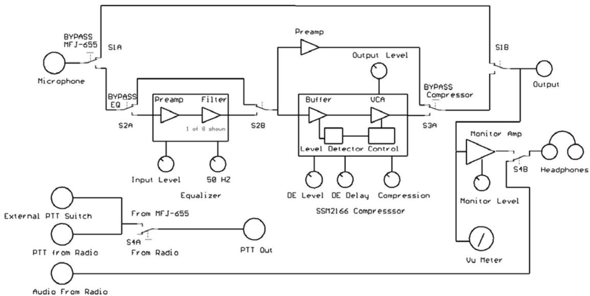
**Figure 15: Block Diagram**
